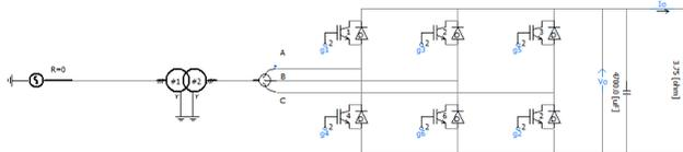
Figure 12. 3-Phase PWM Rectifier Circuit
